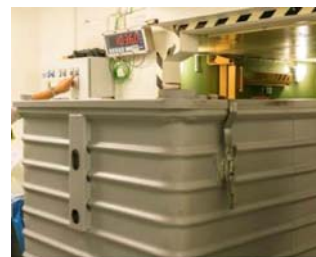
図 10. ISOCS 測定セルへの物質の投入
