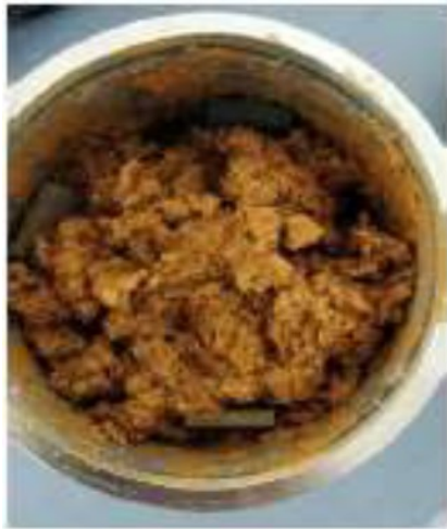
図 6. スラリーとガラスフリットの混合物を装填した坩堝
